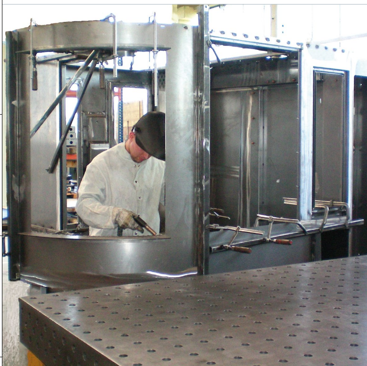
Hier werden Maschinenkabinen in einem Stück gefertigt.
