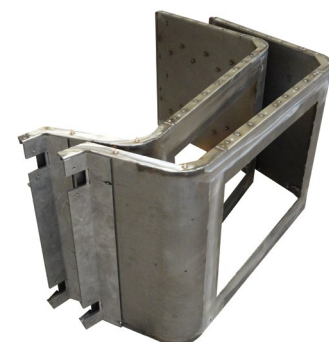
Hier werden Maschinenkabinen in einem Stück gefertigt.
