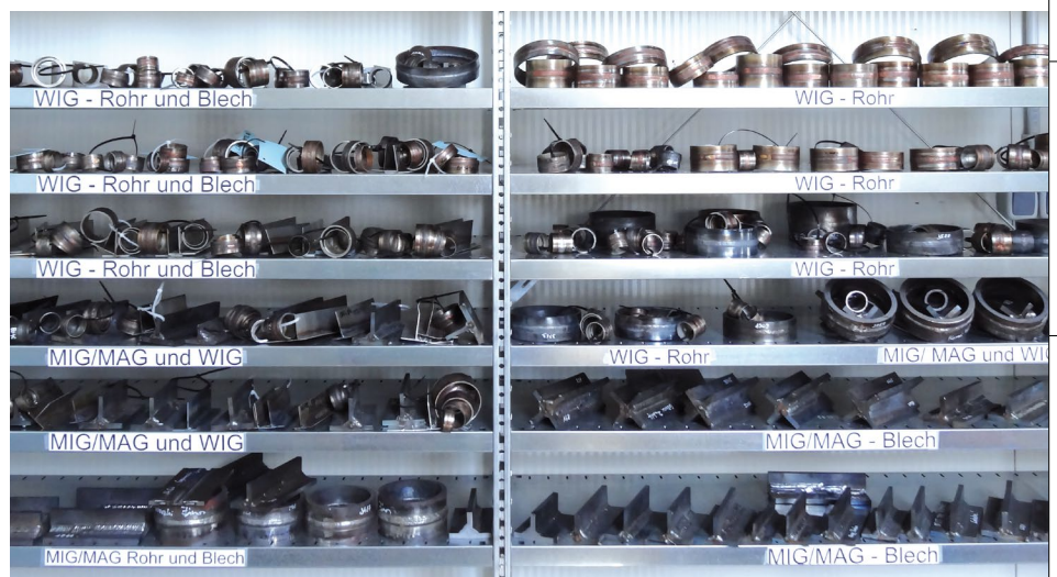
Das Bild zeigt einige Prüfstücke der Schweißer, die unseren Anforderungen gerecht wurden und damit bei europakraft gebucht werden können.
